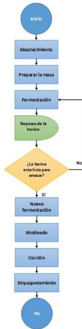
Figura 15: Flujograma del Proceso de Elaboración
